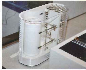
写真1 自記式記録計（計測値を自ら記録する器械、記録紙上段は温度、下段は湿度）
