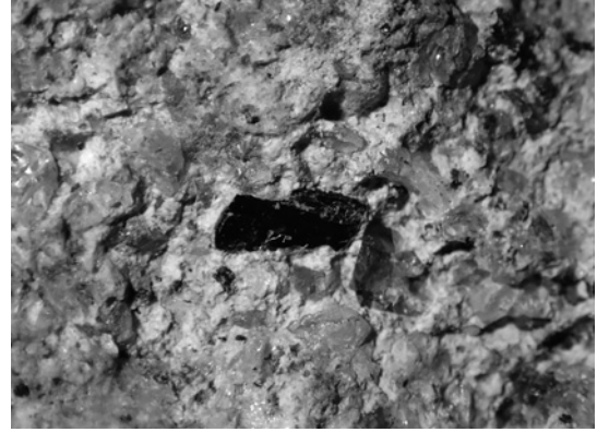
6-2 採石場Loc.2の岩石に含まれる角閃石の結晶 長径約3.3mm
