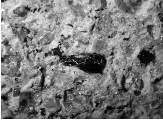
6-1 採石場Loc.1の岩石に含まれる角閃石の結晶 長径約3.4mm
