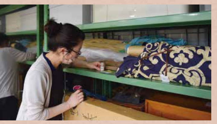
害虫やカビのテストサンプルを設置し、燻蒸後、確実に殺虫・殺菌ができたか確かめます。
