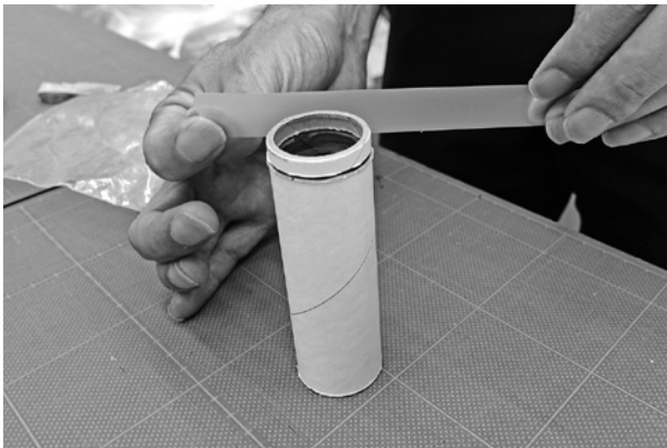
図3 万華鏡の「本体」を作成している様子 長い紙筒と短い紙筒で偏光フィルムを挟み、周りをテープで巻いている様子。
