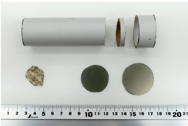
図版2 (左) 万華鏡の作成に用いた材料 上側左：紙筒（長さ9 cm×外径2.7 cm），上側中央：紙筒（長さ0.5 cm×外径2.7 cm），上側右：紙筒（長さ2 cm×外径3.2 cm） 下側左：白雲母，下側中央：偏光フィルム（直径2.7 cm），下側右：偏光フィルム（直径3.2 cm）
