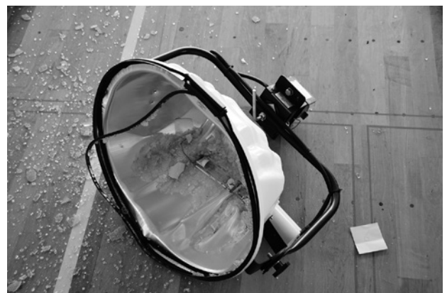
写真2 落下した体育館照明
