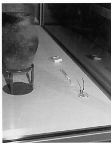
写真一 展示ケース内の各種ガス濃度の調査。資料の横に3個並んで集めるサンプル用のガス捕集器が写っています。
